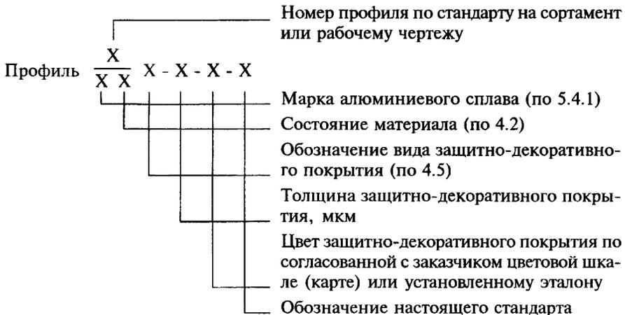
Пример условного обозначения профиля номера по чертежу СПЛ 01-001 из алюминиевого сплава марки АД31, закаленного и искусственно состаренного (Т1), с белым порошковым покрытием (П), толщиной 60 мкм по цветовой шкале RAL 9016:
