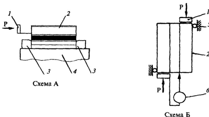
1 — суппорт; 2 — образец; 3 — упор; 4 — стол; 5 — жесткая опора; 6 — силоизмерительное устройство
